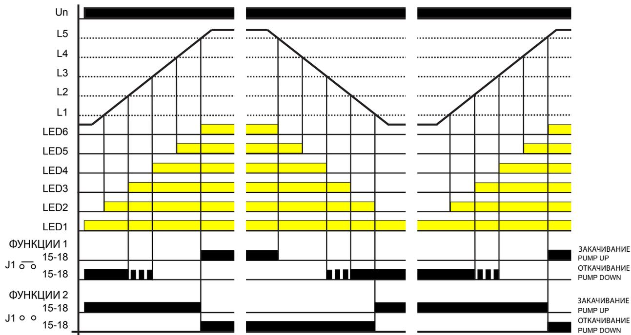
Устройство предназначено для контроля за уровнем токопроводящей жидкости в баках при помощи шести простых зондов или одного шестикратного зонда. В случае использования токопроводящего бака возможно использовать бак вместо одного совместного зонда С.
