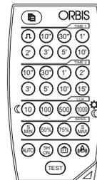
При изменении настроек CIRCUMAT PRO с пульта дистанционного управления новые параметры будут превалять над параметрами, заданными вручную на самом датчике ранее. Если после настройки с пульта происходит изменение настроек вручную, то ручная регулировка будет преобладать.
