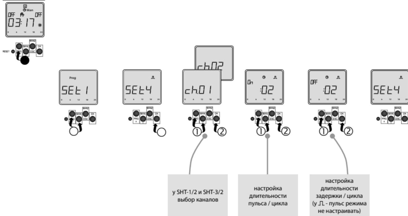
Настройка времени включения пульса / цикличного режима проводится в **SET 1**.
