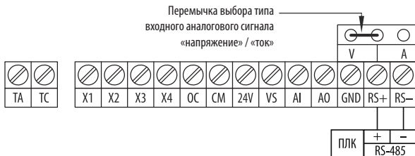
Рисунок 26 – схема подключения ПЧ к ПЛК по интерфейсу RS-485.
