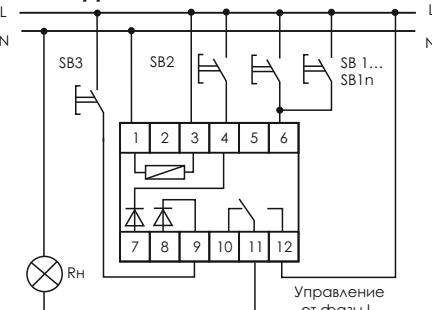
SB1...SBn – кнопочный выключатель управления «Включение-Отключение» нагрузки;
