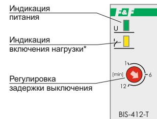
\* Индикатор мигает – включен таймер, нагрузка подключена.
