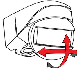
Поворачивая головку датчика по горизонтали ( $\pm 45^\circ$ ) и вертикально ( $\pm 15^\circ$ ) зона обнаружения может быть изменена.
