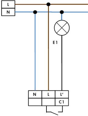
Стандартный режим с 1-канальным датчиком движения с постоянной функцией света
