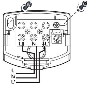
Крепление в разъем с двумя винтами и прилагаемыми уплотнительными кольцами на неподвижную опору.
