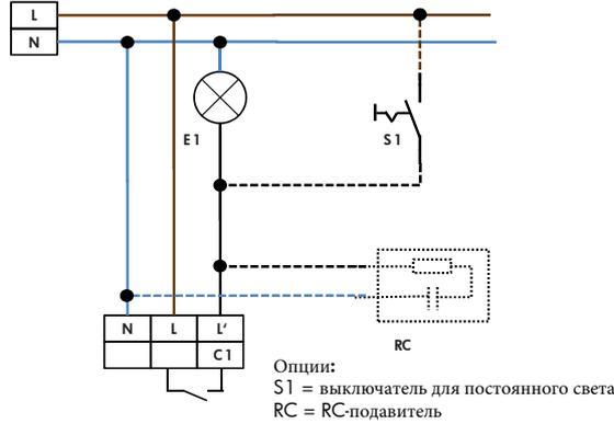
Стандартный режим 1-канального датчика движения с NC кнопкой
