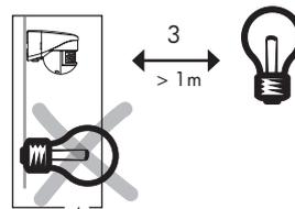
3) Минимальное расстояние до коммутируемого освещения, фронтально или сбоку от устройства: не менее 1 м
