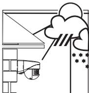
1) Если возможно монтируйте устройство в безопасном месте (на стене под крышей)
