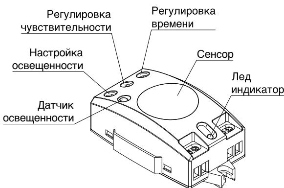
Датчик Движения ECOMAT может обнаруживать малейшие движения, производимые в зоне обнаружения, благодаря используемой высокочастотной технологии. Его чувствительность не зависит от температуры окружающей среды. Прибор сразу обнаруживает перемещение любых предметов, даже таких как стулья, двери и т.д. Область обнаружения ECOMAT MINI составляет до 10 м. Угол обнаружения составляет 360°
