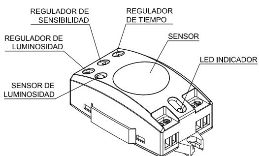
El detector de movimiento ECOMAT MINI es capaz de detectar el más mínimo movimiento gracias a su tecnología de alta frecuencia. Su precisión de detección no depende de la temperatura ambiente. Detecta de forma inmediata cualquier movimiento, incluso elementos inertes como por ejemplo: puertas o sillas.
