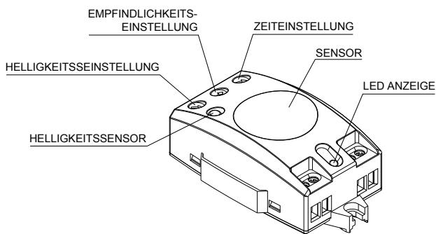
Der Bewegungsmelder ECOMAT MINI kann die geringste Bewegung erfassen dank seiner Hochfrequenztechnologie. Seine Erfassungsgenauigkeit hängt nicht von der Umgebungstemperatur ab. Das Gerät erfasst sofort jede Art von Bewegung, sogar unbewegliche Elemente wie z.B. Türen oder Stühle. ECOMAT MINI verfügt über eine Reichweite von bis zu 10 m mit einem Erfassungsbereich von 360°.
