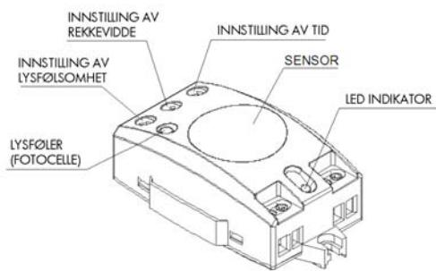
ECOMAT MINI er en bevegelsesdetektor som fanger opp selv minste bevegelser ved hjelp av den innebygd høyfrekvensteknologien. Sensoren følsomhet blir ikke påvirket av omgivelsestemperaturen. Den detekterer umiddelbart alle bevegelser (også bevegelige komponenter, slik som dører, stoler, etc.). ECOMAT MINI har en detekteringsradius på 5 meter, med 360° detekteringsvinkel.
