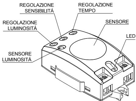
Il rivelatore di movimento ECOMAT MINI è in grado di individuare il minimo spostamento grazie alla tecnologia ad alta frequenza. La precisione di rilevamento non dipende dalla temperatura ambiente. Rileva in modo immediato qualsiasi movimento, inclusi gli elementi inerti, come per esempio: porte o sedie.
