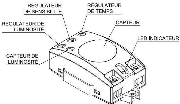
Le détecteur de mouvements ECOMAT MINI est capable de détecter le moindre mouvement grâce à sa technologie de haute fréquence. Sa précision de détection ne dépend pas de la température ambiante. Il détecte immédiatement tout mouvement, et même des éléments inertes comme des portes ou des chaises, par exemple.
