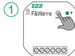
После подключения к сети питания приемника (исполнительного устройства F&Wave) нажать и удерживать кнопку PROG до тех пор, пока не включится нагрузка на выходе и погаснет индикатор связи с символом  $\Psi$ .
