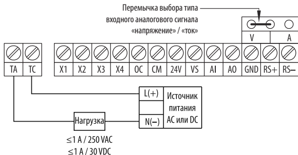
Рисунок 23 – схема подключения нагрузки к релейному выходу (питание от внешнего источника питания постоянного или переменного тока).
