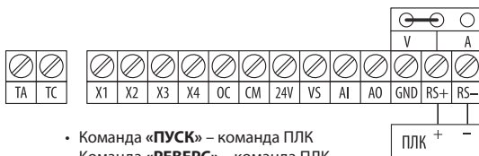
Рисунок 36 - подача команд «Пуск/Стоп» по интерфейсу RS485
