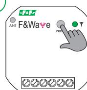
После подключения к сети питания приемника (исполнительного устройства F&Wave) нажать и удерживать кнопку PROG до тех пор, пока не включится нагрузка на выходе и погаснет индикатор связи с символом  $\Upsilon$ .
