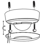
Датчик устанавливается на твердой и ровной поверхности. Перед установкой необходимо снять круглую крышку- кольцо (поверните против часовой стрелки).
