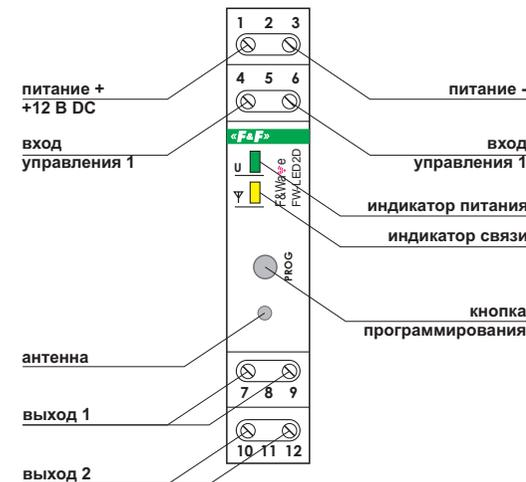
**Схема подключения модуля FW-LED2D**
