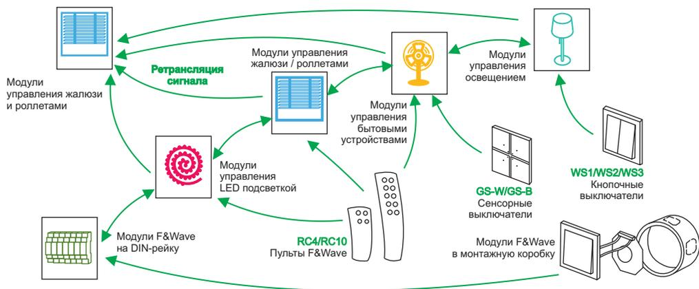
F & Wave - это семейство беспроводных радиоуправляемых устройств с диапазоном до 100 м\*. Приемники поставляются в версии для монтажа на DIN-рейку (корпус 1S) и в коробке для скрытого монтажа Ø60.
