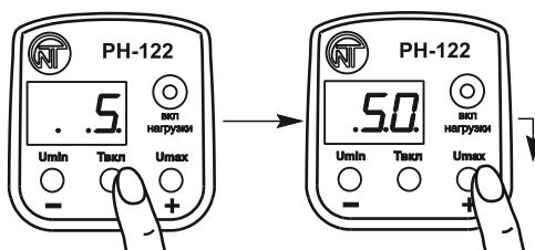
Нажмите кнопку **Tкл** – на дисплее отобразится заводская установка параметра с мигающими точками (**.5.**)
