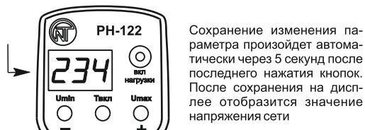
Сохранение изменения параметра произойдет автоматически через 5 секунд после последнего нажатия кнопок. После сохранения на дисплее отобразится значение напряжения сети
