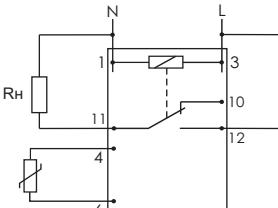
**Внимание!!!: цепи датчика не имеют гальванической развязки от сети питания. Не допускается погружение датчика в жидкость без принятия дополнительных мер по его гидроизоляции.**
