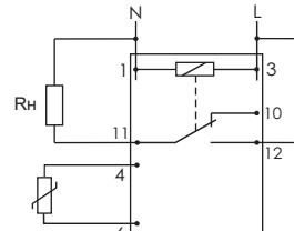
**Внимание!!!: цепи датчика не имеют гальванической развязки от сети питания. Не допускается погружение датчика в жидкость без принятия дополнительных мер по его гидроизоляции.**
