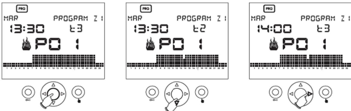
Используйте **▲** и **▼** клавиши, чтобы выбрать новую температуру, чтобы подтвердить или **►**, чтобы перейти на новый интервал времени. Нажмите **[OK]**, чтобы завершить температурный профиль.
